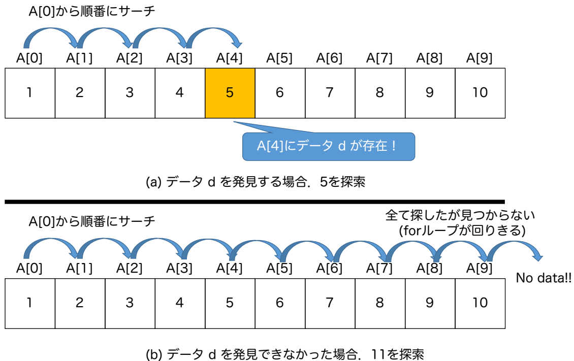
図2 LinearSearch.java の挙動の図式化. (a) 線形探索により配列内からデータを発見する, (b) 発見できなかった場合のプログラムの挙動を示している.
