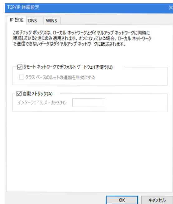
図 9.16: デフォルトゲートウェイの設定解除
